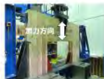
③ せん断試験の例 (壁-壁壁)
