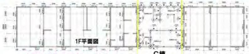
A棟(CLT長尺スクリュー工法) C棟(軸組工法) B棟(CLT告示金物工法)
